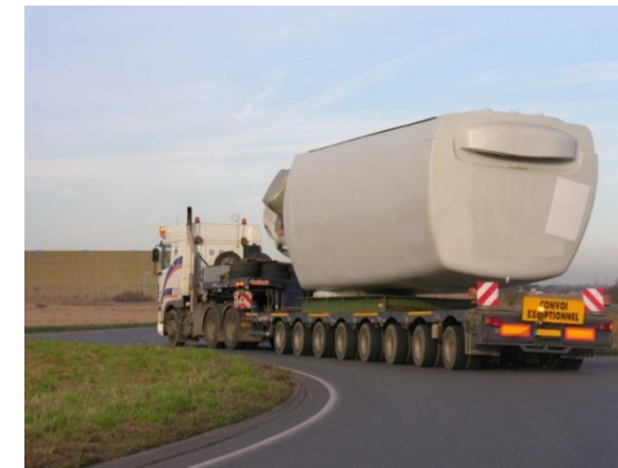
Transport de la nacelle
